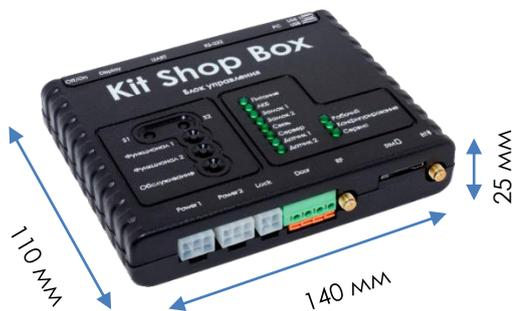
**Kit Shop Box** - специально разработанный нами многофункциональный блок, выступающий центральной платой управления в решении класса Умный холодильник/закрытая витрина.
